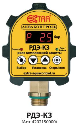
Электронные реле комплексной защиты по давлению «EXTRA® Акваконтроль» серии **РДЭ-КЗ** объединяют в себе реле “сухого хода” и реле превышения давления и предназначены для защиты трубопроводов, насосов или иного оборудования от работы при высоком и низком давлении в системе.
